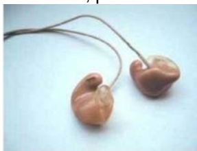
Figura 5. Monitor intraauricolari personalizzati (Fonte: Linee guida europee [1]).
